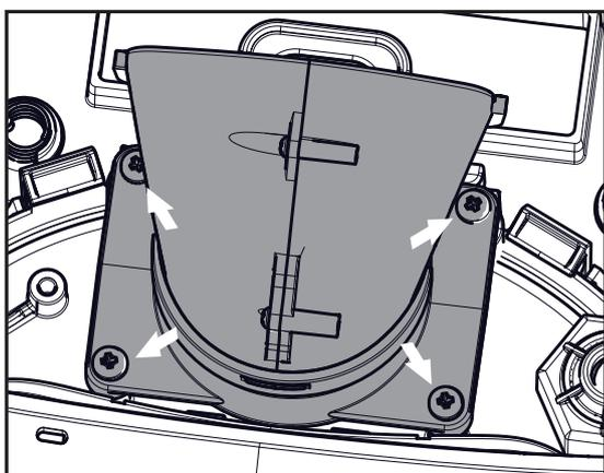
5. Retire los 4 tornillos y retire el colector de agua.
