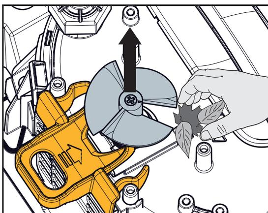
6. Si es necesario, retire el tornillo del impulsor y levante el impulsor con cuidado pero con firmeza para limpiar los residuos.
