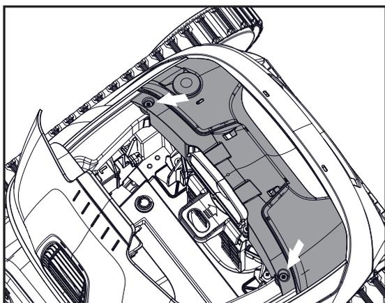
3. Retire 2 tornillos y retire la cubierta.
