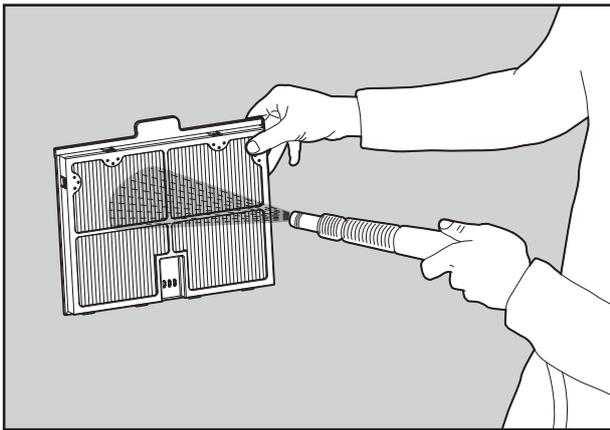
Limpiar los paneles de filtración con una manguera.
