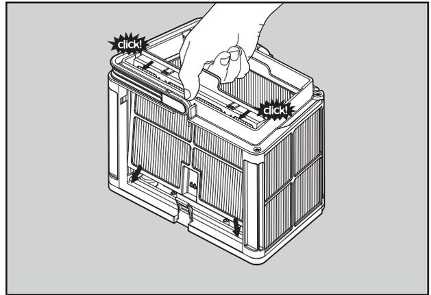
Montar los paneles de filtración.
