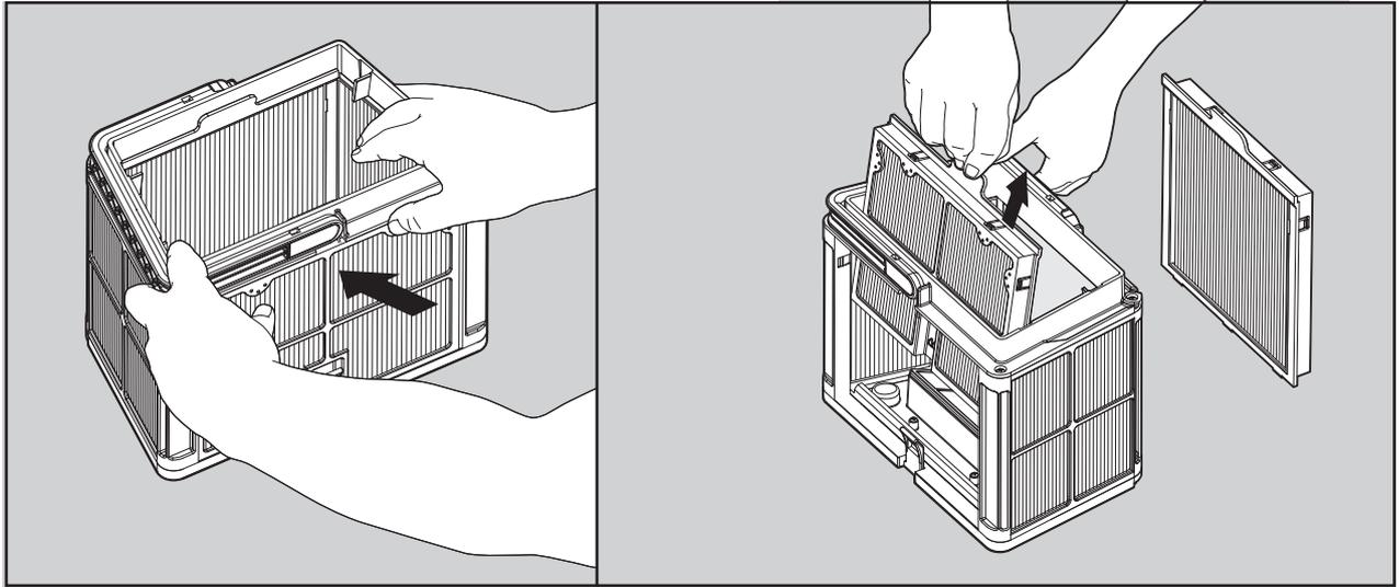
Desacoplar los 2 paneles usando los pulgares.
